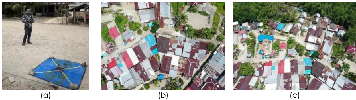
Gambar 6. (a) Penerbangan UAV, (b) sudut perekaman 90°, (c) 70°.
